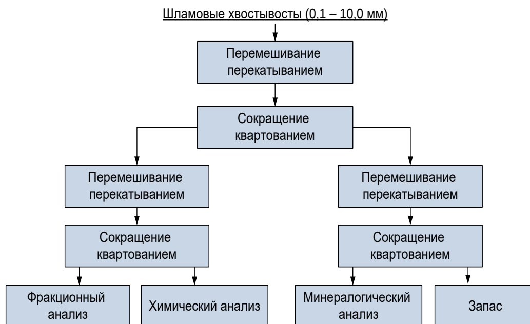
Рисунок 1 – Схема разделки шламовых хвостов
