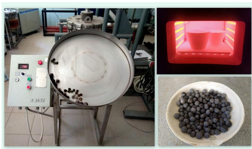
Рисунок 15 – Лабораторный тарельчатый гранулятор (а) и муфельная печь (б), используемая для наработки обожженных окатышей (с)
